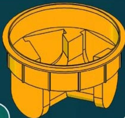
کفی منهول پلی اتیلن به قطر ۱۰۰۰ میلی متر بصورت چهارراهی ماهیچه دار (INVERT)، با یک ورودی مستقیم، دو ورودی ۴۵ درجه و یک خروجی حداکثر تا سایز لوله ۴۰۰ میلی متر.
