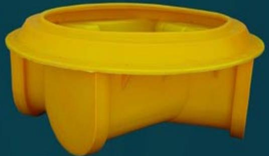
کفی منهول پلی اتیلن به قطر ۱۲۰۰ میلی متر بصورت چهارراهی ماهیچه دار با یک ورودی مستقیم، دو ورودی ۴۵ درجه و یک خروجی، حداکثر تا سایز لوله ۴۰۰ میلی متر.
