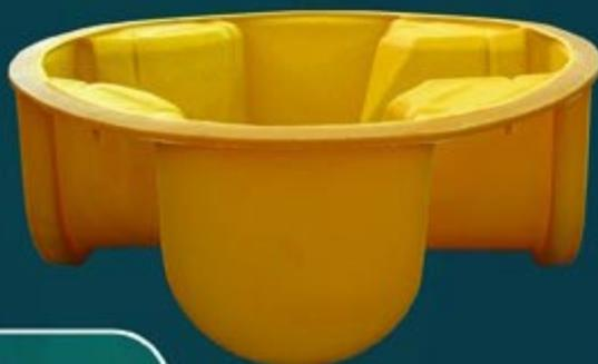
کفی منهول پلی اتیلن به قطر ۱۲۰۰ میلی متر بصورت چهارراهی ماهیچه دار با یک ورودی مستقیم، دو ورودی ۴۵ درجه و یک خروجی، حداکثر تا سایز لوله ۴۰۰ میلی متر.
