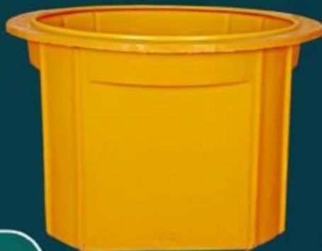
کفی منهول پلی اتیلن به قطر ۱۰۰۰ میلی متر بصورت چهار وجهی بدون ماهیچه (Box Type) برای سایز لوله ورودی و خروجی حداکثر تا سایز ۴۰۰ میلی متر. مناسب برای شرایطی که اختلاف ارتفاع ورودی و خروجی حداکثر تا ۳۵ سانتی متر وجود دارد.
