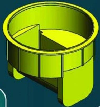
کفی منهول پلی اتیلنی به قطر ۱۲۰۰ میلی متر بصورت دو راهی ماهیچه دار با یک ورودی و یک خروجی مستقیم و حداکثر تا سایز لوله ۵۰۰ میلی متر.
