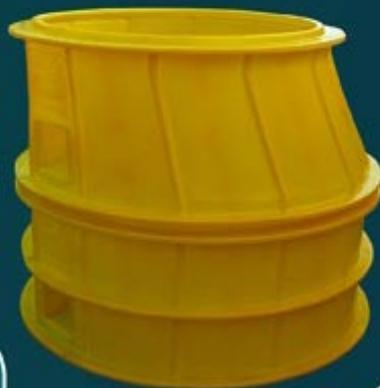
رایزر تبدیلی، یا قطعه میانی تبدیلی جهت افزایش عمق منهول های پلی اتیلنی قطر ۱۲۰۰ میلی متر به میزان ۱۰۰ سانتی متر و هم زمان تقلیل قطر منهول از ۱۲۰۰ میلی متر به ۱۰۰۰ میلی متر مورد استفاده قرار می گیرد.
